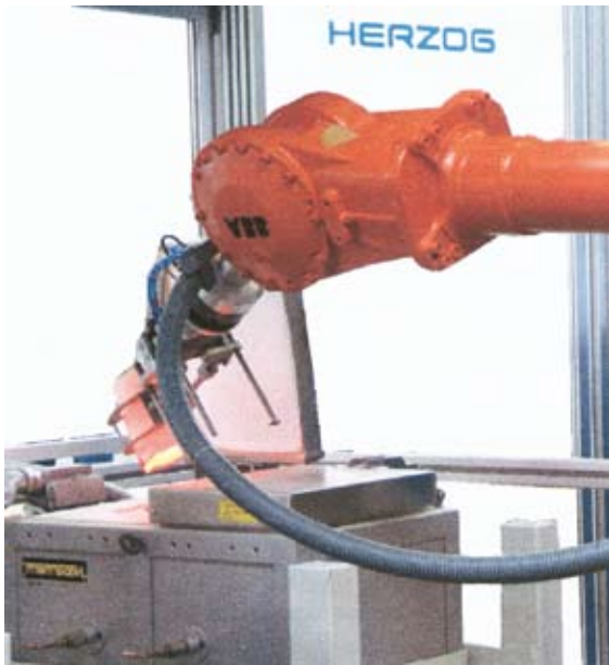
Abbildung 6: Trennung der Bleischmelze von der Schlackenphase in einem beheizten Separator-Tiegel, aus dessen Boden die Bleischmelze in eine gekühlte Stahkokille fließt.
