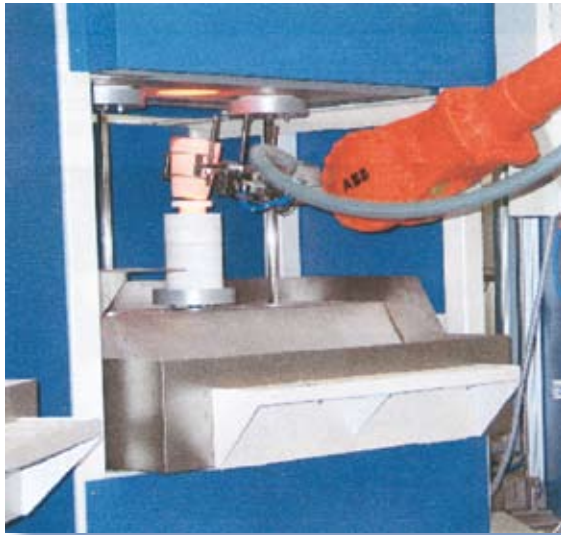
Abbildung 5: Elektroöfen für den simultanen Aufschluss von drei Erzproben bei 1200 Grad Celsius.
