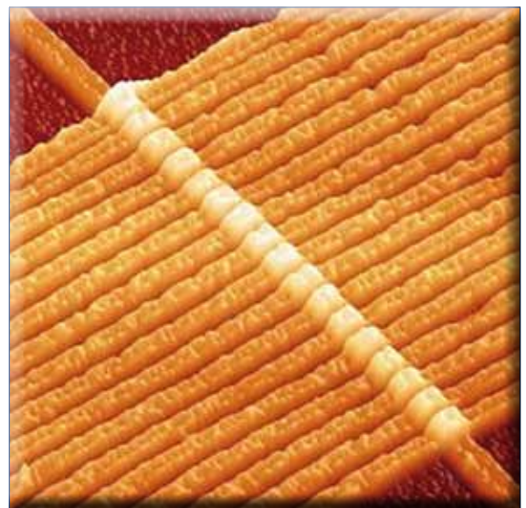
Abbildung 12: Aufnahme des in den Laboren von Hewlett Packard hergestellten Schichtverbundes von 17 Memristoren mittels eines Rasterkraftmikroskops (Abb.: J. J. Yang, HP Labs).
