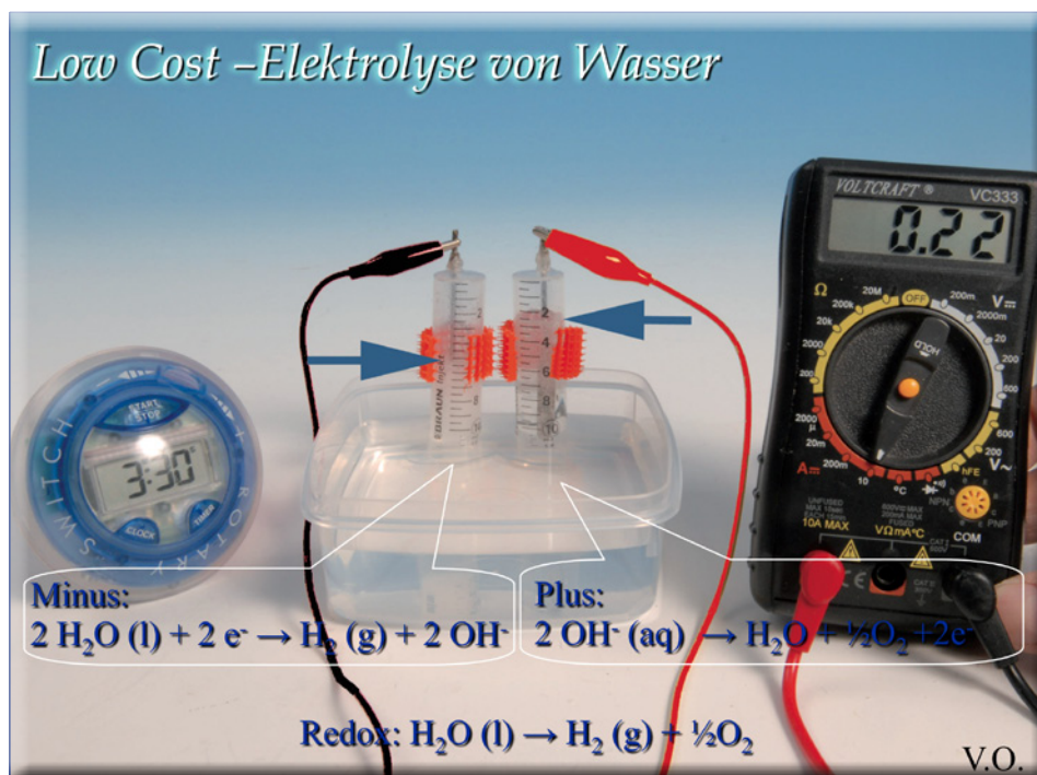
Abbildung 4: Ein Standardversuch in der Elektrochemie ist die Elektrolyse von Wasser. Wie sich das mit einfachen Mitteln bewerkstelligen lässt hat Viktor Obendrauf beschrieben (Abb.: Obendrauf).
