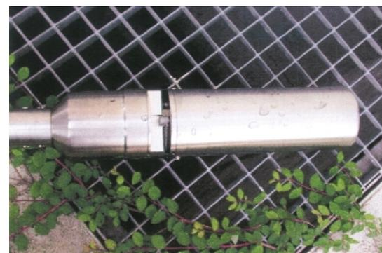
und ohne den Einsatz von Reagenzien den Gehalt an Nitrat. Wo die Messung direkt im Medium aus bautechnischen Gründen nicht möglich ist, bietet sich eine Bypass-Lösung an.
