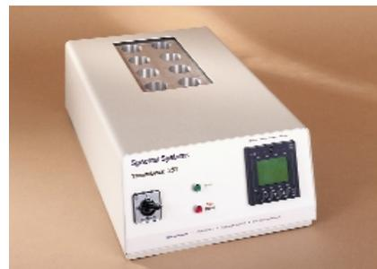
In der Standardausführung beinhaltet der Thermoblock eine stufenlose Temperaturregelung bis 250 °C. Die Aufheizzeit auf die Maximaltemperatur beträgt ca. 10 Minuten.
