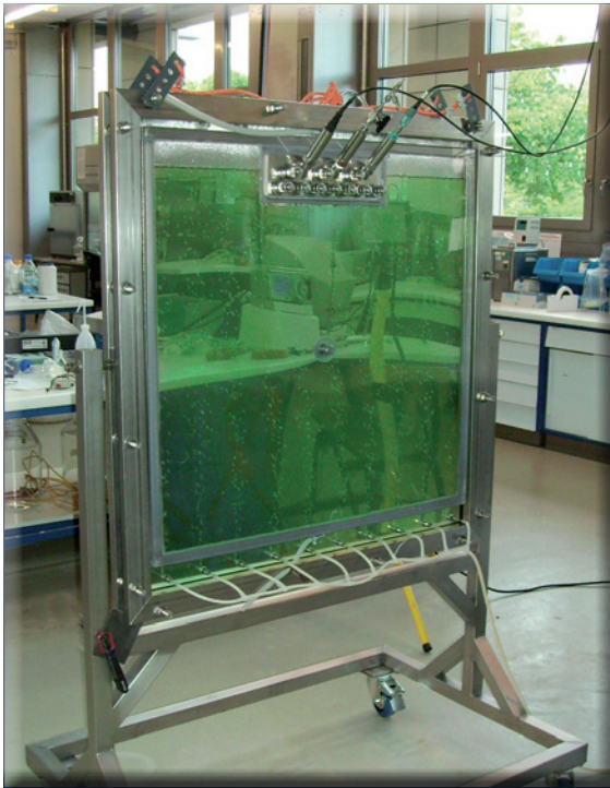
Abbildung 9: Platten-Photobio- reaktor des KIT.
