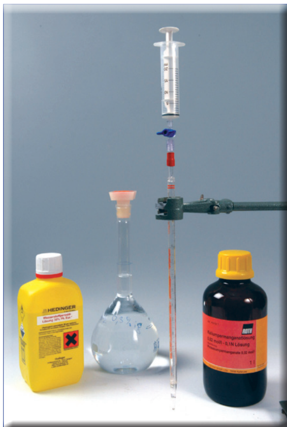
Abbildung 16: Manganometrische Bestimmung der handelsüblichen Wasserstoffperoxid-Lösung (30%ig an Masse). Als Low-Cost-Bürette dient eine 10mL-Vollpipette aus Kunststoff, die mittels Gummi- beziehungsweise PVC-Schlauchstück mit dem Luer-Anschluss eines Einweghahnes oder mit der 20mL-Spritze verbunden wird. Das Reagenz wird nur bis zur 0,0mL-Markierung der Pipette (Bürette) angesaugt. Das tropfenweise Zusetzen der Lösung erfolgt durch Drücken auf den geöhlten Spritzenstempel wie bei einer Kolbenhubpipette.
