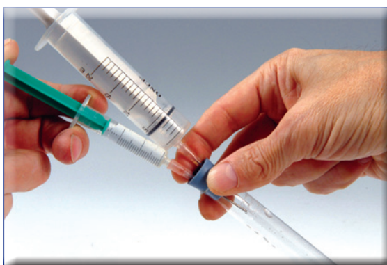
Abbildung 12: Handhabung des Gasentwicklers ohne Stativ und mobil: Stopfen, Kanülen und Reagenzglas werden mit drei Fingern einer Hand fixiert, während mit der anderen das Reagenz zudosiert wird.
