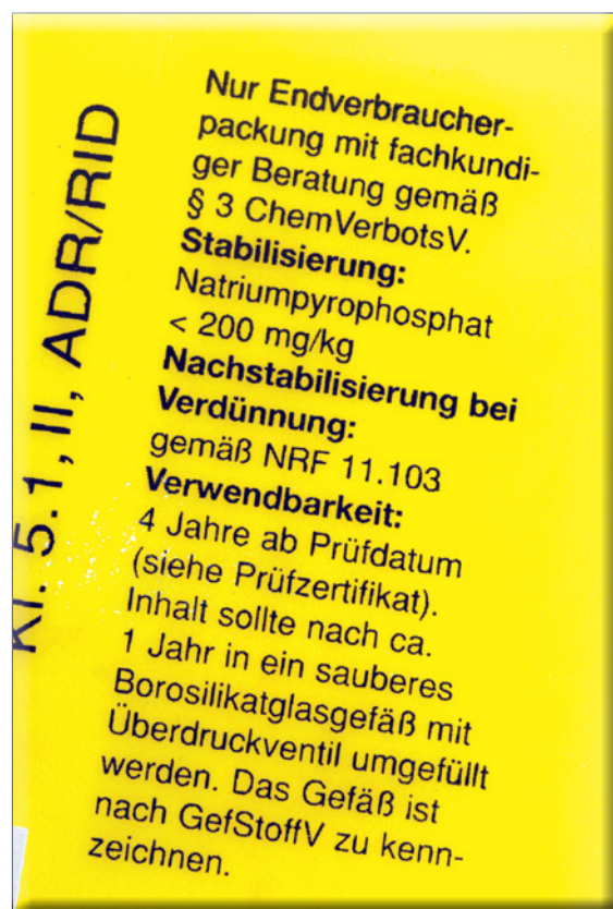
Abbildung 11: Beschriftung einer 1Liter- \text{H}_2\text{O}_2 -Flasche 30%ig – nach 1 Jahr Lagerung sollte man trotz Stabilisator für ein Gebinde mit Druckentlastung sorgen.
