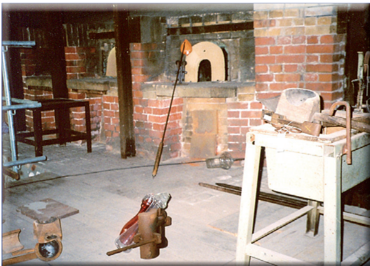
Abbildung 6: Glasschmelzofen (mit Häfen) in der Fischerhütte.
