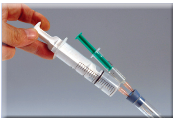
Abbildung 13: Handhabung des Gasentwicklers: einem etwaigen Überdruck wird durch Erzeugung von Unterdruck vorgebeugt. Mit zwei Fingern wird am Spritzenstempel gezogen, ein Finger hält die Spritze in der Kanüle in Position.
