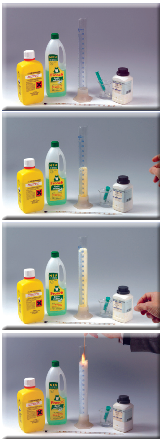
Abbildungen 17-20: Bildung einer vorausberechneten Sauerstoffschaum-Säule im 250 mL-Messzylinder. Mittels aufflammendem Holzspan lässt sich der eingeschlossene Sauerstoff auch nachweisen.
