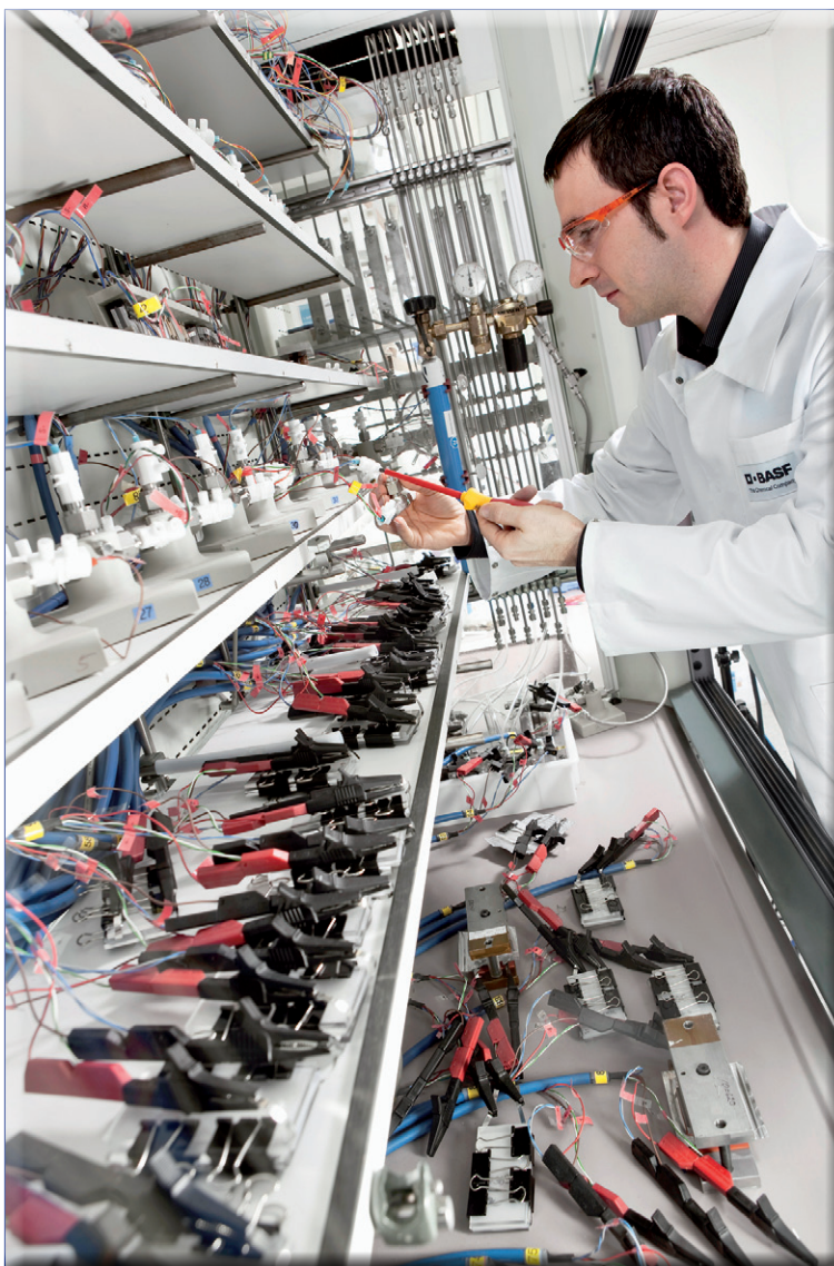
Christian Saffert, Chemielaborant bei der BASF, überprüft am „Multi-Kanal Testsystem“ die Speicherkapazitäten verschiedener Lithium-Ionen-Testbatterien (siehe dazu auch das Titelbild dieser CLB; Abb.: BASF)..
