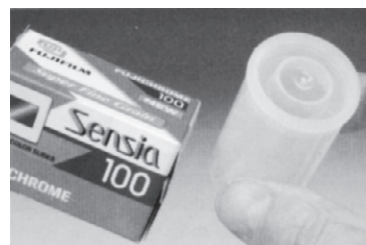
Abbildung 7: Sublimation von Trockeneis in der Fuji-Filmdose; der Schnappdeckel ist essentiell.
