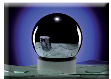
In der Silicium-Kugel des Avogadro-Experiments spiegelt sich eine Kopie des Kilogramm-Prototyps (Abb.: PTB).
