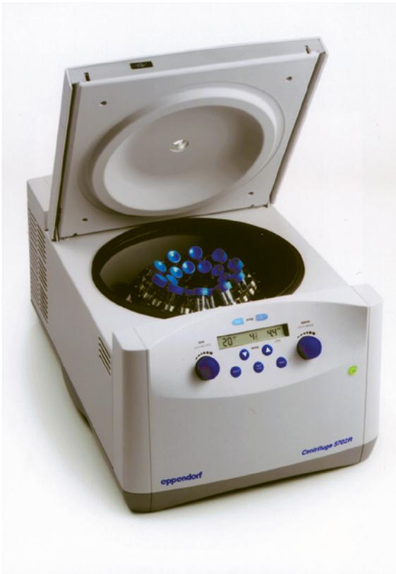
Die Centrifuge 5702 R zeichnet sich durch intuitive und komfortable Bedienung aus. Die eingestellten Werte werden anschaulich auf dem digitalen Display dargestellt, durch Piktogramme werden gewählte
