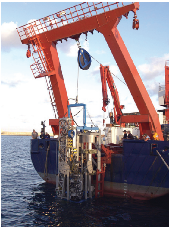
Abbildung 8: Feuertaufe im Ozean: MeBo im Juli 2005 kurz vor der Jungfernfahrt zum Meeresgrund. Über ein Aussetzgestell wird das Meeresboden-Bohrgerät vom Forschungsschiff „METEOR“ abgeseilt (Foto: V. Diekamp, MARUM, Universität Bremen).
