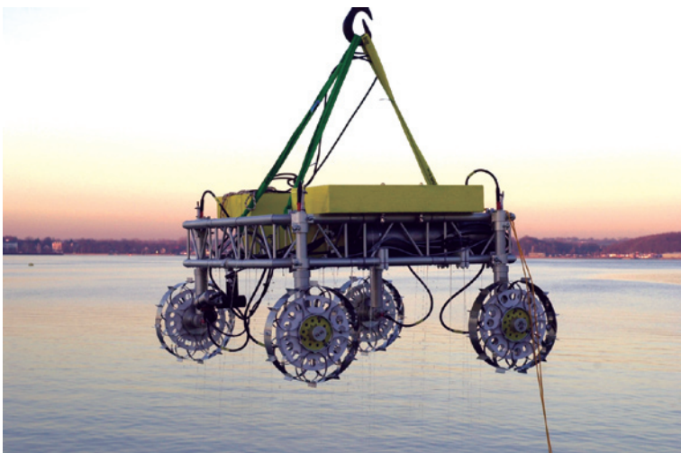
Abbildung 9: Noch baumelt das Unterwasserfahrzeug MOVE! in der Luft. Gleich wird es zum Einsatz in einem norwegischen Fjord ins Wasser gelassen (Foto: MARUM, Universität Bremen).
