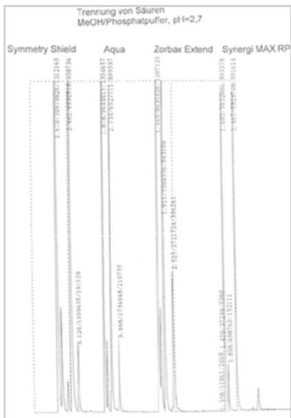
Abb. 5: Trennung von Uracil (Marker), Isohomovanilinsäure (IVS), 3,4 Dihydroxyphenyllessigsäure (DOPAC), 5-Hydroxyindol-3-essigsäure (HIES) und 4-Hydroxy-3-methoxymandelsäure (HVS) an vier verschiedenen Säulentypen
