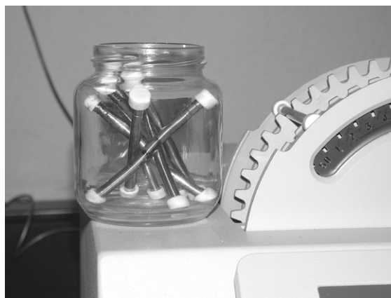
Abbildung 2: ATD-Adsorptionsröhrchen für die Headspace-Analyse (Foto: Martin).
