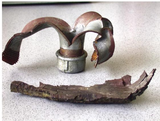
Abbildung 5: Detonierete Rohrbombe (alle Fotos dieser Doppelseite: Martin).
