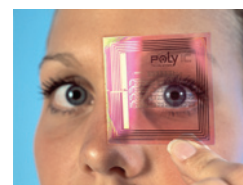
Zum Titelbild: Der druckbare Kunststoffchip mit einer Taktfrequenz von 600 KHz (Foto: Poly-IC, s. S. 48).
