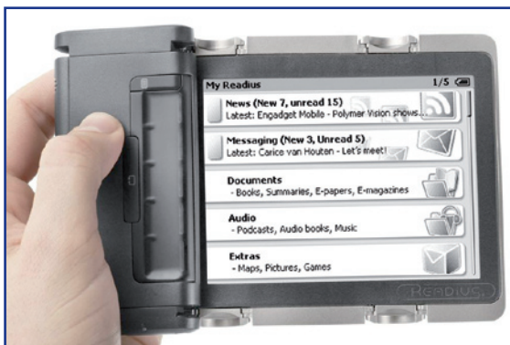
Abbildung 7: Das Readius-Handy mit ausrollbarem Polymerbildschirm, gezeigt von der Phillips-Tochter Polymer Vision auf dem Mobile World Congress im Februar in Barcelona (Abb.: Polymer Vision).
