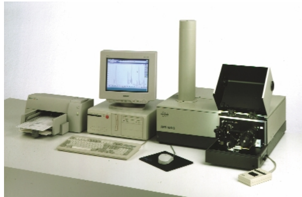
Das Titelbild zeigt die Eingangsoptik des RFS 100/S mit einer Probe (Quarzküvette)
