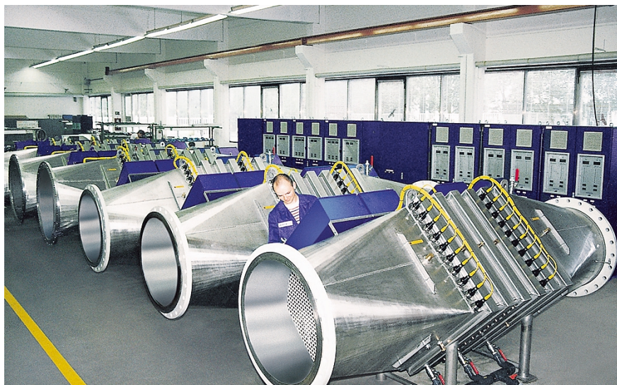
Abb. 2: Wedeco-K-Anlagen für die Trinkwasserdesinfektion. (Foto: Wedeco AG, Düsseldorf).
