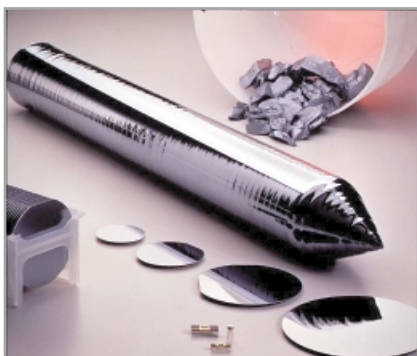
Abbildung 1: Reinstsilicium, Siliciumeinkristall aus dem Czochralski-Verfahren und Silicium-Wafer verschiedener Größen zur Herstellung von integrierten Schaltkreisen.
