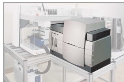
Abbildung 1 Das PSQ 96-Analysesystem eignet sich vor allem zur exakten Sequenzierung kurzer bis mittellanger DNS-Abschnitte von 20 bis 30 Basen Länge.
