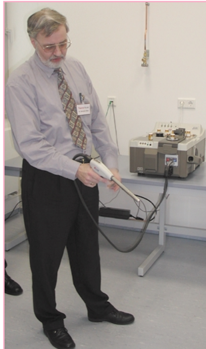
Dr. Hermann Belz demonstriert die Funktionsweise eines Faseroptikanalysators zur Messung von Proben außerhalb des NIR-Gerätes.
