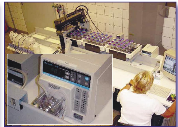
Abbildung 2: Aufbau der automatischen BSB_5 -Bestimmung Kleines Bild: Schlauchpumpe zur Probendosierung.
