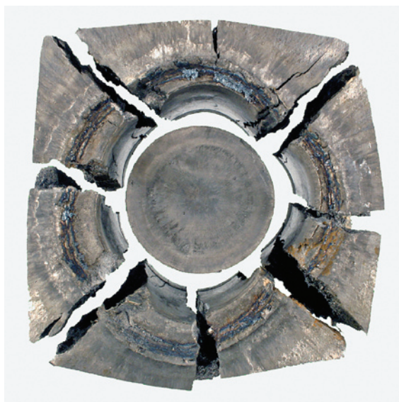
Nach dem Sprengversuch ist der Stahlklotz durch die starken Druckwellen zerstört. Der Probenbehälter im Zentrum, in dem sich zwischen zwei Gesteinsplatten die Mikroorganismen befinden, ist noch intakt (Abb.: Fraunhofer EMI).
