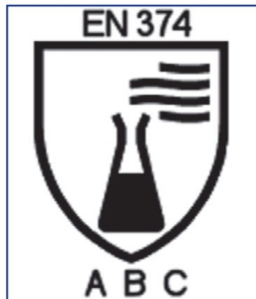
Piktogramm nach Euronorm EN 374 zur Kennzeichnung von Schutzhandschuhen.
