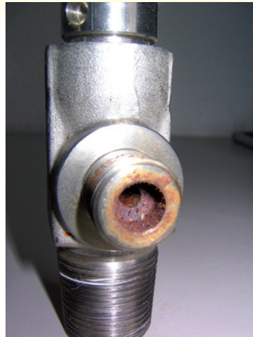
Abbildungen 3a und b: Ventile von innen. Der richtige Umgang mit Gasgemischen schützt vor Feuchte (links) und Korrosion (rechts) im Inneren des Flaschenventils.
