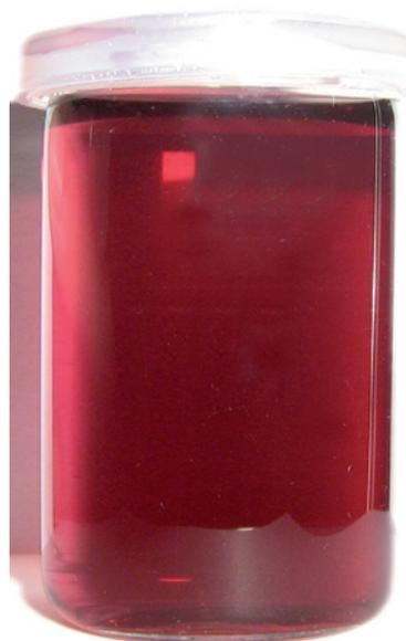
Abbildung 2: Eine kolloidale Goldlösung wird durch Reduktion von Gold-III-chlorid in wässriger Lösung mit Zinn-II-chlorid hergestellt. Sie enthält purpurfarbiges, kolloidal gebundenes Gold auf Zinndioxid als Trägermaterial (Foto: Wolfgang Kühn).
