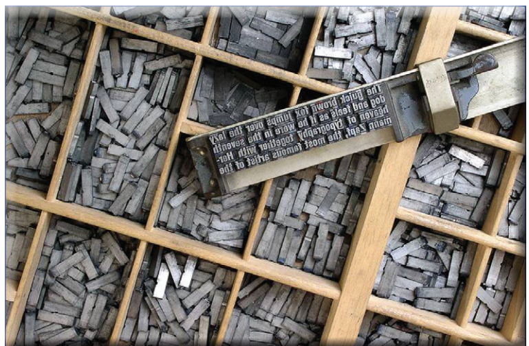
Abbildung 13: Alter Lettern-Satz für den Buch- und Zeitungsdruck.
