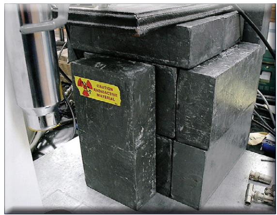
Abbildung 15: Blei-Abschirmung bei Arbeiten mit radioaktivem Material.
