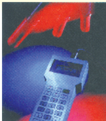
Abbildung 2: Prototyp eines Sprengstoff- sensors auf Basis zyklischer Voltammetrie (Foto: FhG/ICT).
