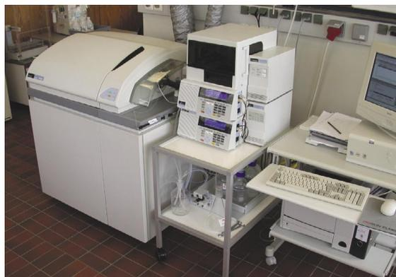
Abbildung 1: HPLC-ICPMS-Anlage (ELAN 6100 mit LC-Pumpe und Autosampler Serie 200, Fa. Perkin-Elmer)
