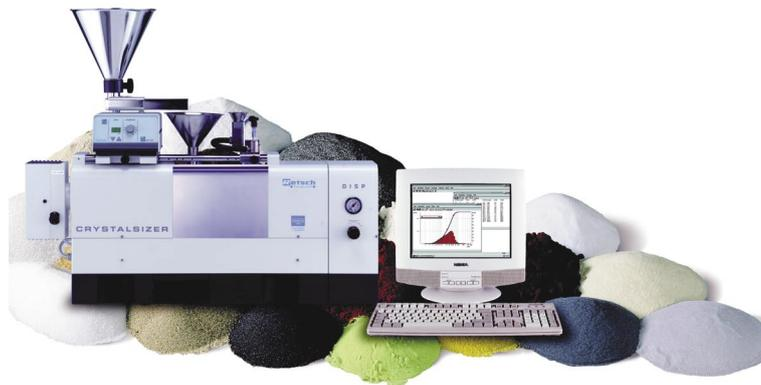
prüft eine Software kontinuierlich die gerätespezifischen Einstellungen und justiert diese erforderlichenfalls nach. Besonders wichtig für einen Einsatz unter Industriebedingungen ist die nun automatisierte Erkennung und Kompensation von Verschmutzungen. Die Wartungsintervalle können dadurch ausgedehnt werden. Neben der hohen Robustheit ist nach wie vor eine optimale Empfindlichkeit für Präzisionsmessungen gewährleistet.
