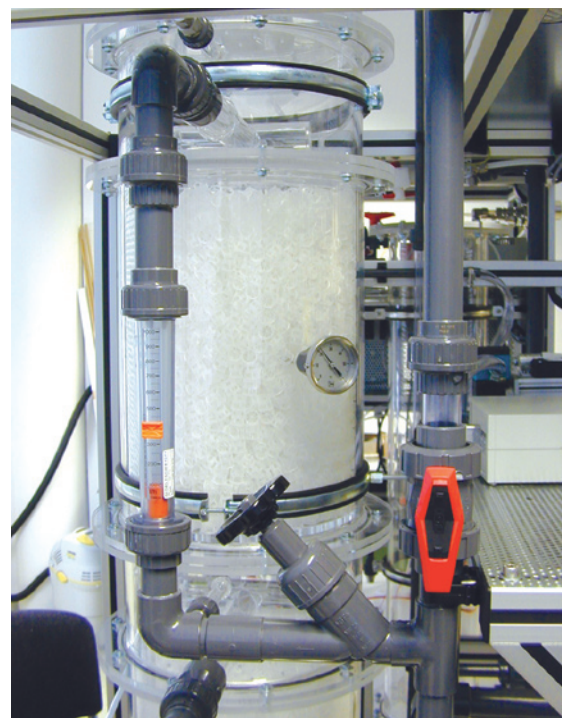
Abbildung 1: Filtersegment der biologischen Entschwefelung nach dem Profactor-Verfahren.
