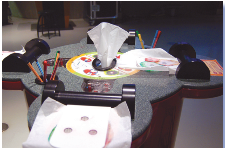
Abbildung 3 (oben): Experimentier-Arbeitsplatz zur Verdeutlichung des Prinzips der Chromatographie mit Hilfe von Farbstoffen aus Filzschreibern und Papier.
