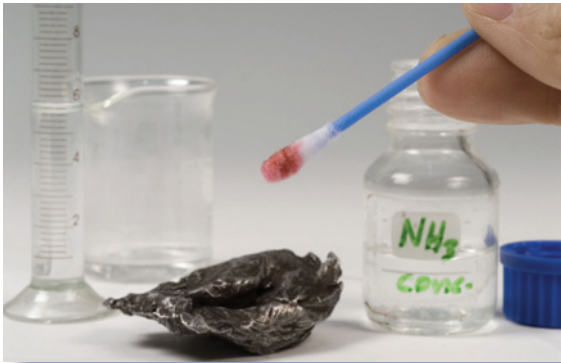
Abbildung 9: Die typische Farbe des Ni-Diacetyldioxim-Komplexes erscheint nach Abpufferung der Säure in der Watte mit Ammoniak.
