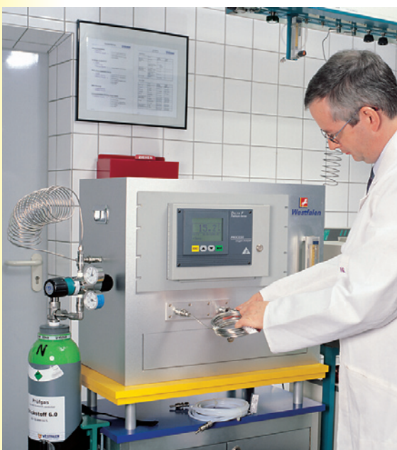
Abbildung 2: Der Versuchsaufbau: Hochreiner Stickstoff wird durch unterschiedliche Schlauchmaterialien geleitet. Der dabei jeweils gemessene Sauerstoffgehalt ist höchst unterschiedlich.
