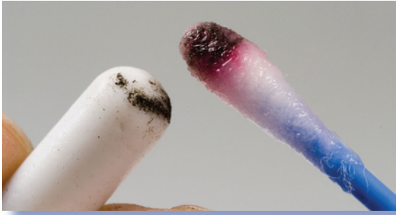
Abbildung 18: Die magnetisierbaren Teilchen auf dem Rührfisch enthalten Nickel. Im Basischen wird auch die braune Farbe von Eisen-III-hydroxid erkennbar.
