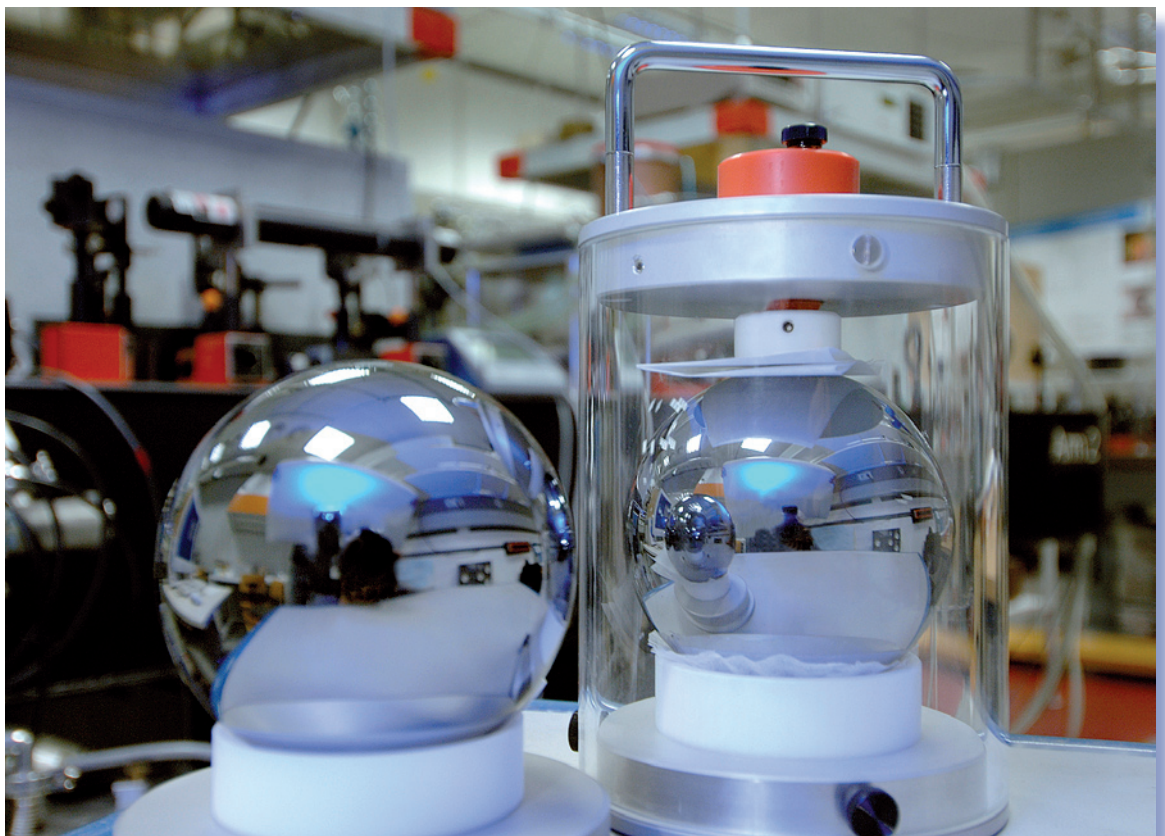
Zwei hochreine Silicium-Kugeln in der PTB. Gerade neu angekommen ist dabei diejenige, die nur aus Atomen des Isotops ^{28}\text{Si} besteht (Foto: PTB).
