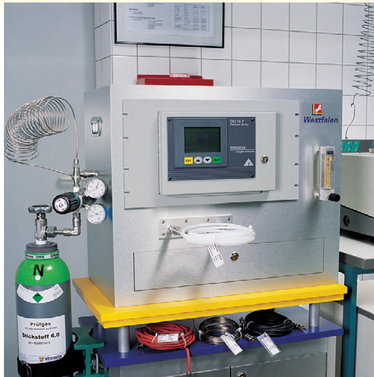
Abbildung 4: Kunststoffschläuche. Die Kunststoffe erhielten beim Modellversuch keine guten Noten. Am besten schnitt noch ein Marken-Kunststoff aus Fluorelastomeren ab (im Bild das schwarze Schlauchteil).
