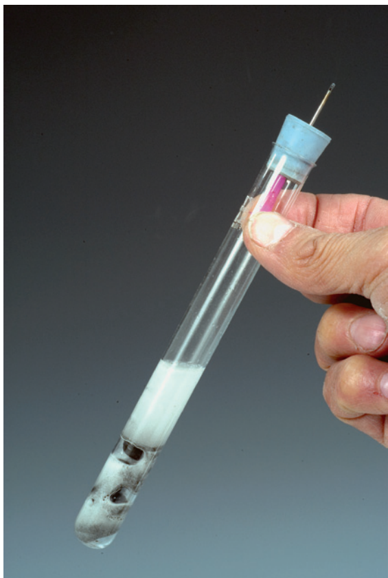
Abbildung 7: Sauerstoff-Generator. An der Kanülenspitze tritt nach Verdrängen der Luft reiner Sauerstoff aus.
