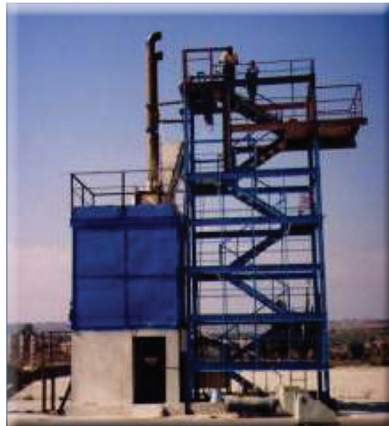
Abbildung 10: Russische Anlage zur Herstellung von Olivenkern-Aktivkohle.
