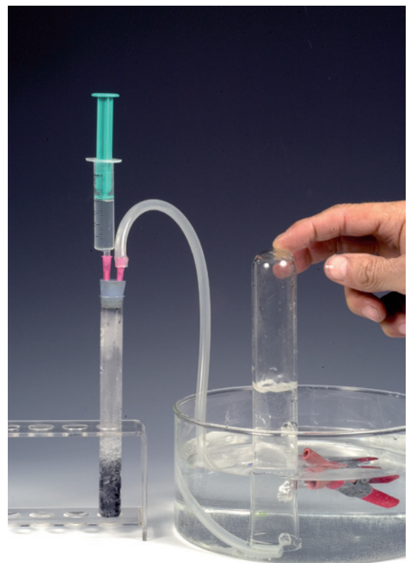
Abbildung 6: Low-Cost-Gasentwickler für Wasserstoff, der im Reagenzglas SB 29 (seitlicher Ansatz verschlossen) gesammelt wird.
