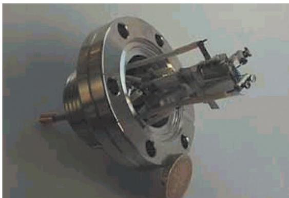
Abbildung 6: Ein Quadrupol-MS im Miniformat.
