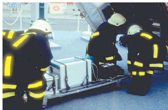
Abbildung 1: Feuerwehrleute verladen ein GC/MS in einen Hubschrauber, um Chemikalien vor Ort zweifelsfrei nachzuweisen. Das System wurde an der Technischen Universität Hamburg-Harburg entwickelt und leistet wertvolle Dienste bei Chemieunfällen und Bränden, bei denen giftige Substanzen entstehen.
