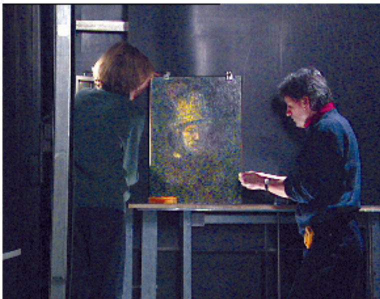
Abbildung 6: „Der Mann mit dem Goldhelm“ im Berliner Hahn-Meitner-Institut: Eingespannt in eine Vorrichtung kann das Bild horizontal und vertikal bewegt werden. Die Neutronen, die durch eine schmale Öffnung aus einem Strahlrohr austreten, bestrahlen nach und nach die gesamte Bildfläche (Abbildung: HMI).
