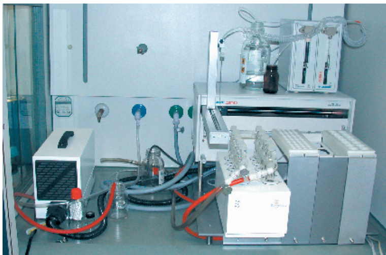
Abbildung 2: Basisgerät für die Screening-Versuche sind automatische Syntheseapparate, in denen jeweils zehn unterschiedliche Ansätze á zehn Milliliter bearbeitet werden können.
