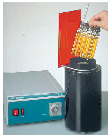
Abbildung 1: Beispiel einer UV-Aufschluss-Apparatur: Die zum Aussenden der UV-Strahlung verwendete 500 Watt Quecksilber-Hochdrucklampe erzeugt auch viel Wärme. Eine intensive Wasserkühlung kompensiert dies.
