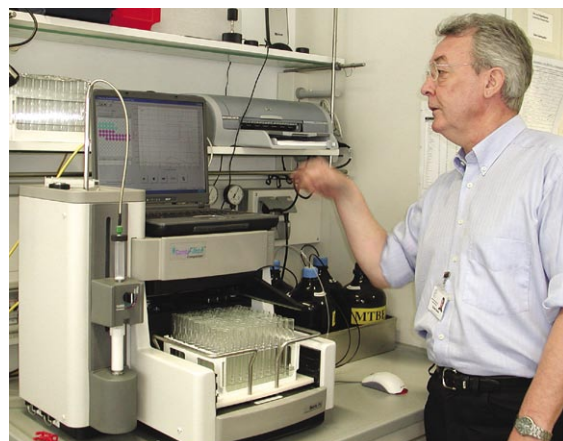
Abbildung 1: Den Chemieingenieur Günter Seidel vom MPI für Kohlenforschung begeistert am „Companion“ der Firma Isco besonders das zum Gerät gehörende Softwarepaket. Es erleichtert die Steuerung und Auswertung der automatisierten Flash-Chromatographie und erfordert seiner Erfahrung nach keine lange Einarbeitungszeit (Fotos: MB).
