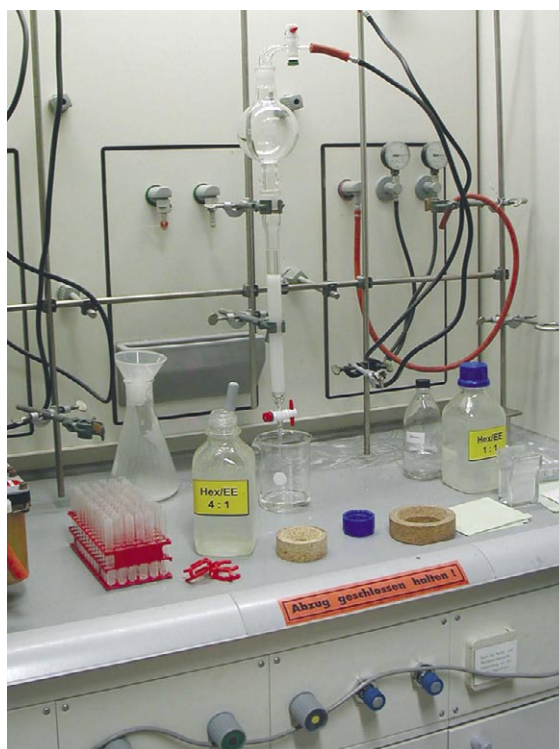
Abbildung 2: Die Säulenchromatographie mit der „Hand-Säule“ erfordert wesentlich mehr Zeit und Lösungsmittel und zudem ständige Überwachung. Sie bietet den Vorteil, dass man unter Schutzgas arbeiten kann.
