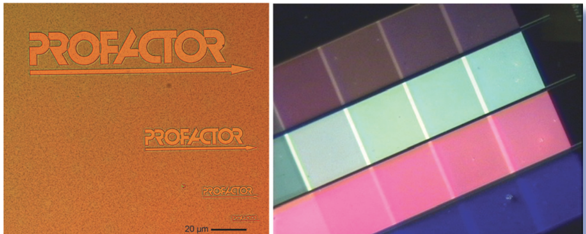
Abbildung 5: Aufnahmen mit einem optischen Mikroskop von geprägten „Profactor“ Logos (kleinste Struktur: 300 nm) und Linien und Schachbrett- Muster (kleinste Strukturen 100 nm)
