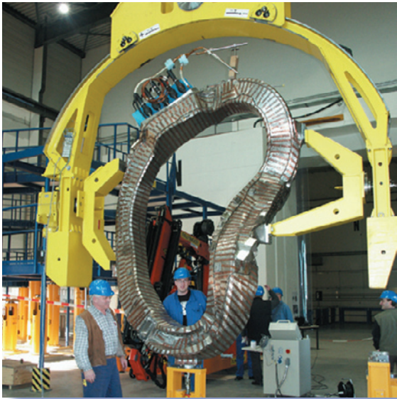
Diese eine von 50 nicht-ebenen Stellarator-Magnetspulen zeigt die Komplexität der Spulengeometrie beim Wendelstein-7X-Stellarator (Foto: IPP).
