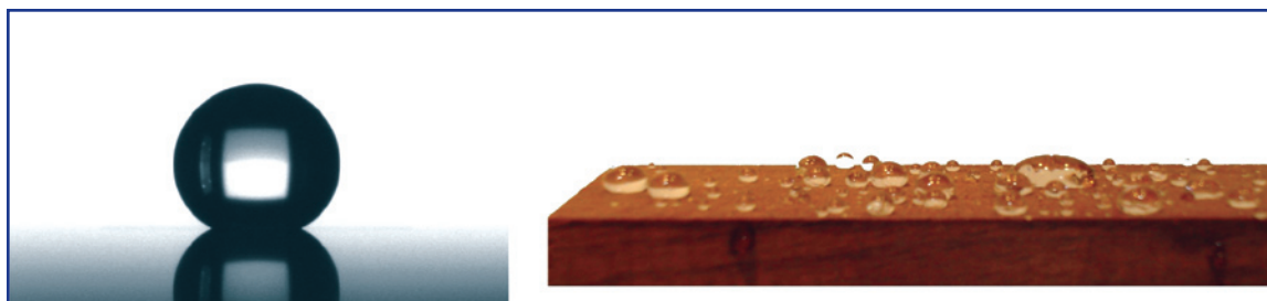
Abbildung 3: Wassertropfen auf beschichtetem Glas (links) und auf beschichtetem, modifiziertem Holz .
