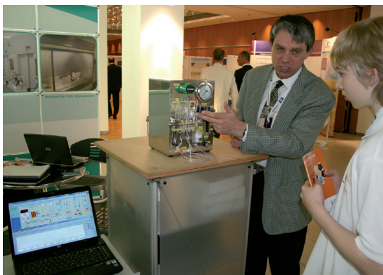
Ein Nachwuchstalent lässt sich auf der begleitenden Ausstellung der Industrie auf der Nuklearmedizin-Tagung in Leipzig von Dr. Jozef Comor ein Synthesegerät für ^{11}\text{C} -Acetat zeigen. Das Gerät von Isotope Technologies Dresden wird mit Zyklotron-erzeugtem ^{11}\text{C} -Kohlendioxid beladen. Die Herstellung zu dem Acetat soll GMP-kompatibel verlaufen (Foto: Kickuth).
