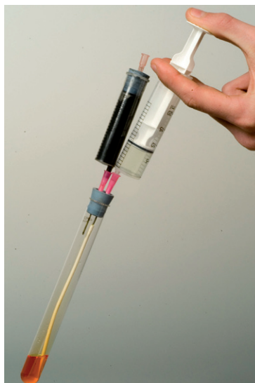
Abbildung 11: Einleiten von Chlor in eine Lösung von Bromid. Es bildet sich Bromwasser, zusätzlich zeigen sich Bromdämpfe. Kleine Bläschen aus der dünnen Nadelverlängerung (Kabelisolierung) sorgen für guten Kontakt. Jede Geruchsbelästigung wird durch das Aktivkohle-Röhrchen vermieden.
