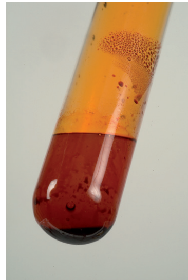
Abbildung 9: Br_2 ist dichter als H_2O . NaBr, verd. H_2SO_4 und H_2O_2 – und es sammelt sich u. a. ein Tropfen Brom am Boden (s. Versuch 9).
