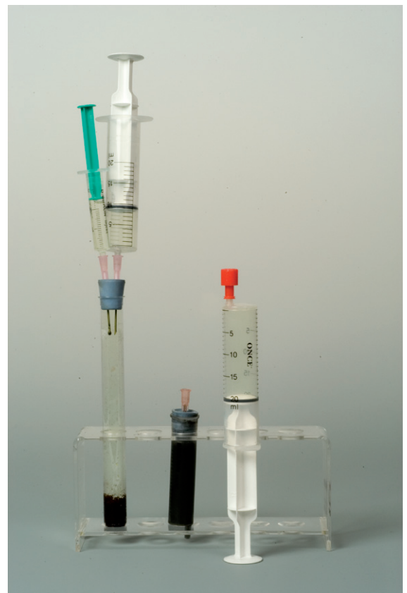
Abbildung 6: Low cost-Gasentwickler zur raschen Darstellung von Chlor, das als gut steuerbares Oxidationsmittel für Bromid zu Brom dient (Beschreibung im experimentellen Teil).
