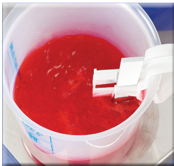
Abbildung 3c: Turbulente Durchmischung mit einem Stromstörer-Clip (Firma Bürkle).
