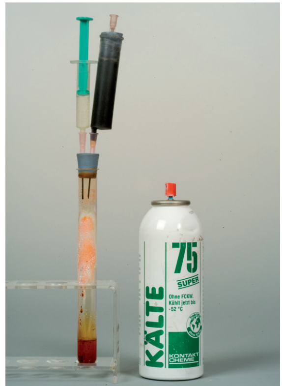
Abbildung 14: Erzeugung von flüssigem Brom in Bromwasser: Am Grunde des Reagenzglases sammelt sich ein Tropfen an flüssigem Brom (s. auch Abb. 9).
