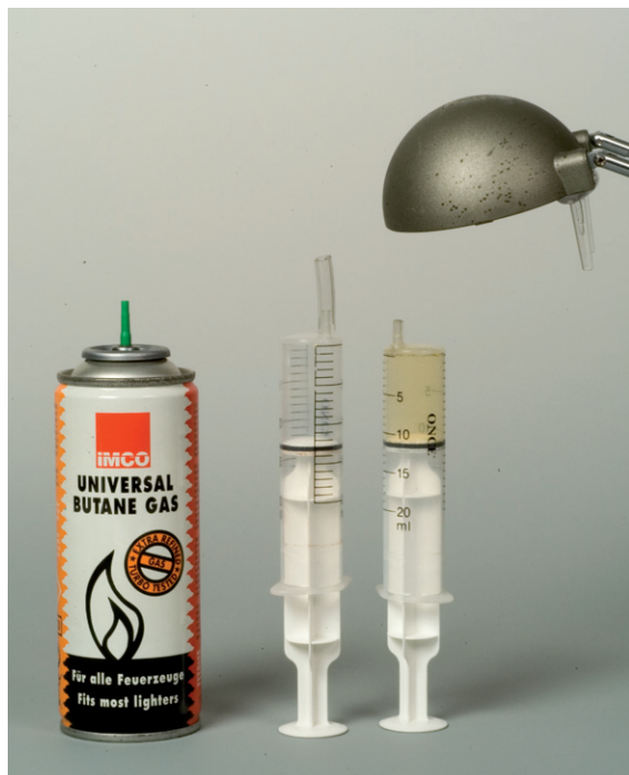
Abbildung 13: Nach dem Mischen der Bromdämpfe mit Feuerzeuggas über das Schlauchstück wird die Reaktion mit Licht gestartet.
