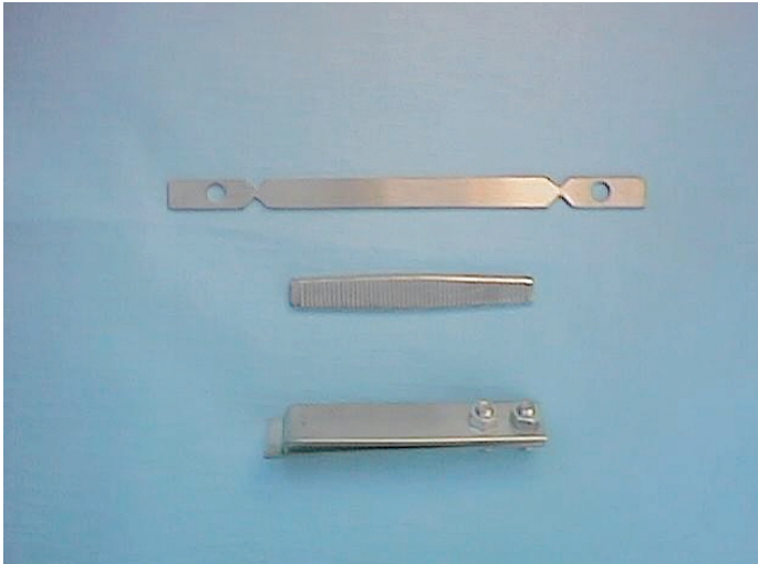
Abb.2: Oben Prüfkörper gemäß DIN 1050, Mitte Prüfkörper (Riffelmodell), Unten Prüfkörper (Spaltmodell)
