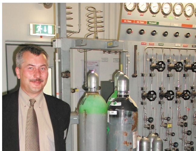
Lutz Thiedecke nennt als ungefähren Preis für die Xenonfüllung der vorderen großen Flasche im bild links 150 000 Mark. Rechts eine Trennanlage für Krypton und Xenon mit zwei Tieftemperatur-Rektifikationen.
