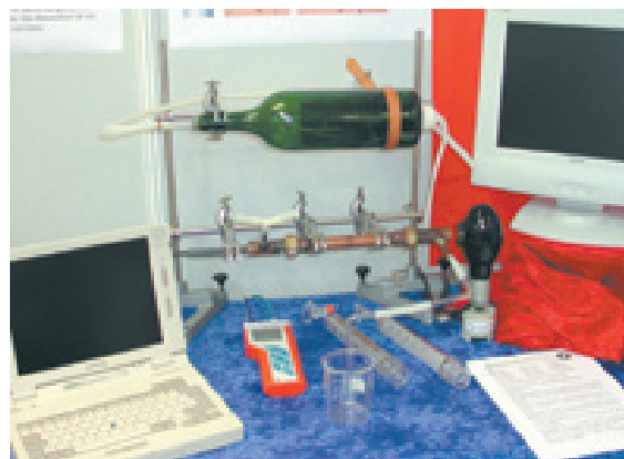
Abbildung 2: Die selbstgebaute Apparatur von Tiede, Arning und Krahl bestimmt Ozon wie ein Photometer.
