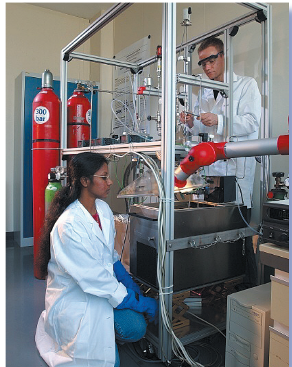
Abbildung 2: Laboranlage zur Untersuchung der Wasserstoff-Speicher-Eigenschaften von Nanopartikeln (Foto: FZK).
