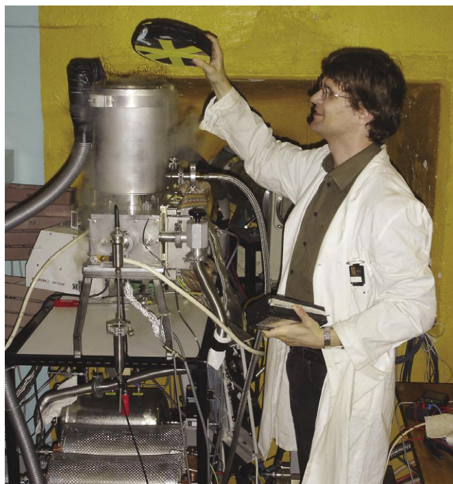
Diese am PSI entwickelte Messapparatur zum Nachweis einzelner Atome soll entscheidend für die Zerfallsmessung beim radiochemischen Experiment in Dubna gewesen sein (Foto PSI).
