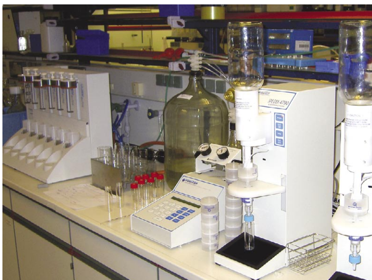
Abbildung 5: Arbeitsplatz für die Probenvorbereitung (rechts: automatisierte Extraktion partikulär belasteter Wässer mittels C18 Speedisk und Horizon Spe-Dex 4790; links: Automat zur Extrakttrocknung und Lösungsmittelaufkonzentrierung Horizon DryVap).
