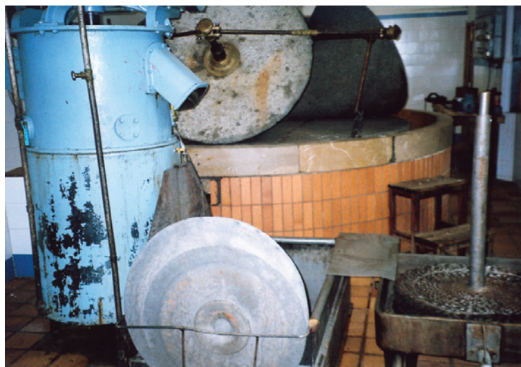
Abbildung 2: Das Mahlwerk der historischen Ölpresse in der Finca Can Det.
