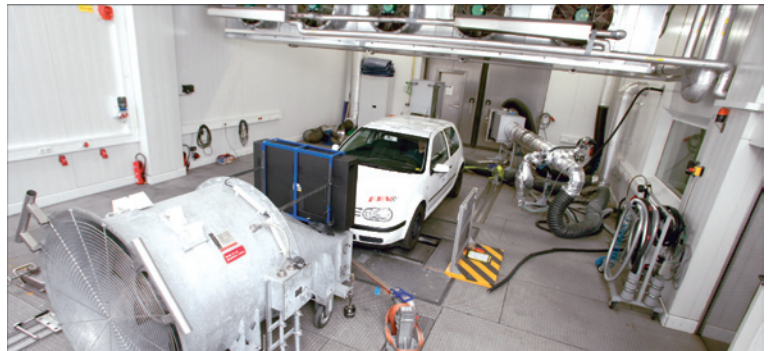
Abbildung 1: Auf Motorprüfständen werden auch die Abgasemissionen untersucht. Verlässliche Werte lassen sich mit den entsprechend kalibrierten Prüfgasen ermitteln. Die Gase-Bereitstellung erfolgt hier üblicherweise über zentrale Versorgungsstationen.
