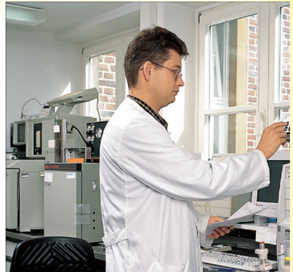
Abbildung 2: Raumluftproben werden mithilfe von Prüfgasen am Gaschromatografen untersucht.
