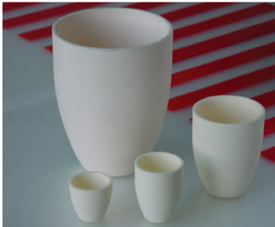
Abbildung 11: Tiegel aus Aluminiumoxid-Keramik.
