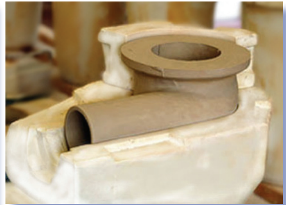
Abbildung 6: Modell- und Formenbau für keramische Werkstücke.
