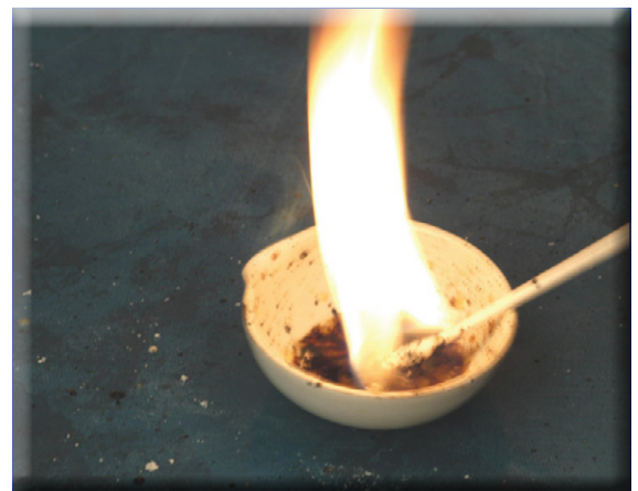
Abbildung 20: Das Gemisch aus Staubzucker und Kaliumchlorat auf dem Wattestäbchen entzündet sich beim ersten Kontakt mit Schwefelsäure.
