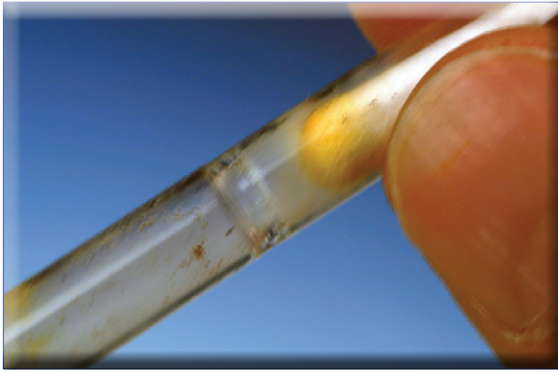
Abbildung 14: Beim langsamen Herausziehen des Wattestäbchens sieht man bereits weißes Phosphoroxid.
