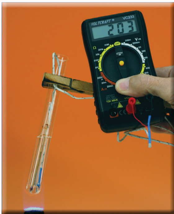
Abbildung 22: Das Low-Cost-Multimeter mit Ni-Cr-Ni-Fühler im Minireagenzglas als perfekter Ersatz für ein Glasthermometer.
