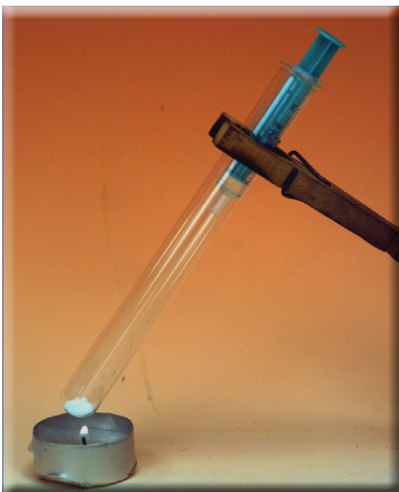
Abbildung 21: Kaliumchlorat reagiert mit Schwefelsäure zu thermisch leicht zersetzlichem Chlordioxid.
