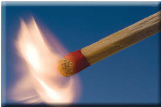
Abbildung 7: Beim elektronischen „Einfrieren“ des Aufflammens lässt sich der hohe K-Gehalt (über 50% Kaliumchlorat siehe Tabelle 1) an der teilweisen violetten Flamme gut erkennen.
