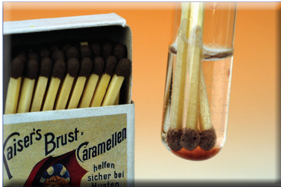
Abbildung 18: Braunstein in den schwarz-braunen Köpfen wirkt als Katalysator bei der Zersetzung von \text{H}_2\text{O}_2 zu \text{O}_2 .
