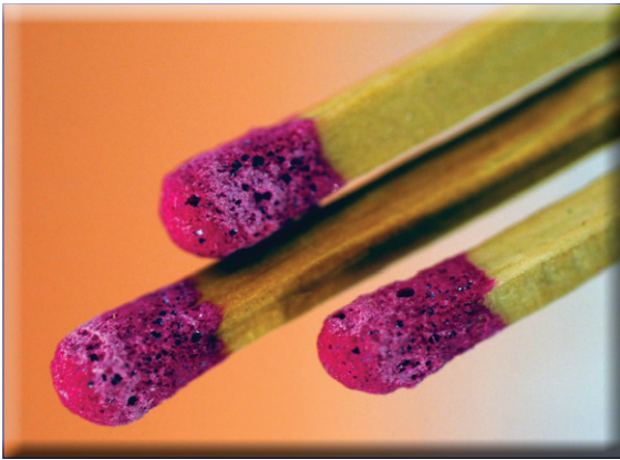
Abbildung 5: Durch das Bindemittel Gelatine erhalten die Köpfchen die typisch schaumige Konsistenz.
