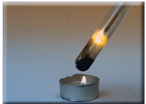
Abbildung 16: Braunstein fungiert als Katalysator: Chlorat liefert bereits bei niedriger Temperatur Sauerstoff, der mit der Glimmspanprobe nachweisbar ist.
