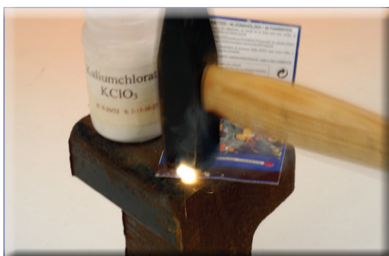
Abbildung 11: Nachweis von rotem P in der Reibfläche durch Reaktion mit wenig \text{KClO}_3 auf Schlag.
