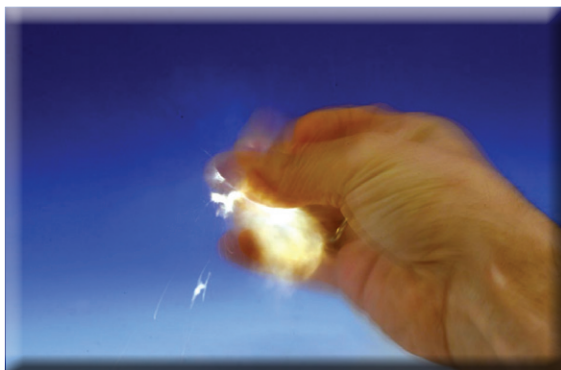
Abbildung 10: „Fingerflash“ – etwa 3 mg getrockneter roter Phosphor reagieren mit einem großen Überschuss an \text{KClO}_3 – ein Modellversuch.
