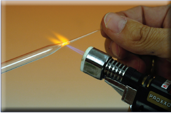
Abbildung 12: Die spitze Flamme eines Lötbrenners eignet sich besonders gut, um aus Pasteurpipetten Mini-Reagenzgläser zu fabrizieren.
