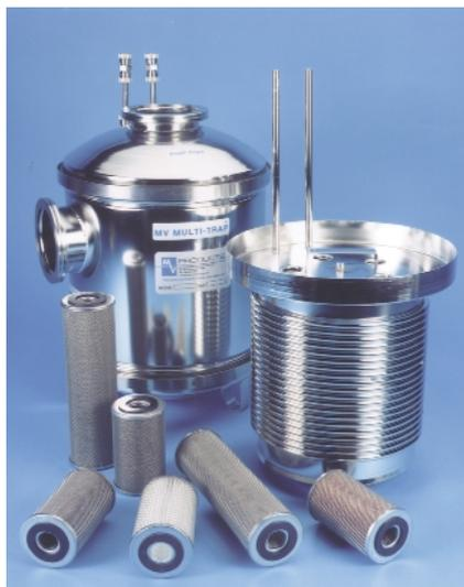
bei denen eine große Menge Kondensat erzeugt wird. Es verfügt über ein Volumen von rund 8200 cc zum Auffangen von Festkörpern und besitzt über 200 % mehr Kühlungsfläche und 25% mehr Kapazität als bisherige Fallen. Es ist vollständig aus rostfreiem Stahl gefertigt und wird mit ISO-80- oder ISO-100-Flansch angeboten. Die beiden Filtrierungsstufen verwenden fünf 112,5 mm große austauschbare Elemente: meistens ein Sieb aus rostfreiem Stahl und mikrondichtem Polypropylen.
