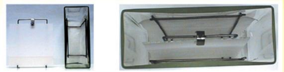
Abb. 4: Links: Entwicklungsgestell mit der DC-Platte, sowie die Kammer mit Filterpapier und dem Haltebogen (seitlich gekippt). Rechts: Entwicklungsgestell mit DC-Platte in der Kammer (von oben).
