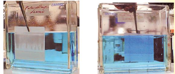
Abb. 5: Links: Tauchung der Platte in die Färbelösung mittels Pinzette. Rechts: Tauchung der Platte mit Entwicklungsgestell.
