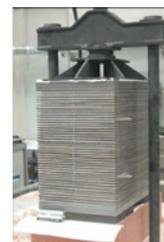
Zum Titelbild: Dieser unscheinbare Plattenstapel kann mit Wasserstoff als Brenngas eine elektrische Leistung von 9,2 Kilowatt erzeugen, ein Weltrekord bei Brennstoffzellen (siehe Seite 271; Abb.: FZ Jülich).
