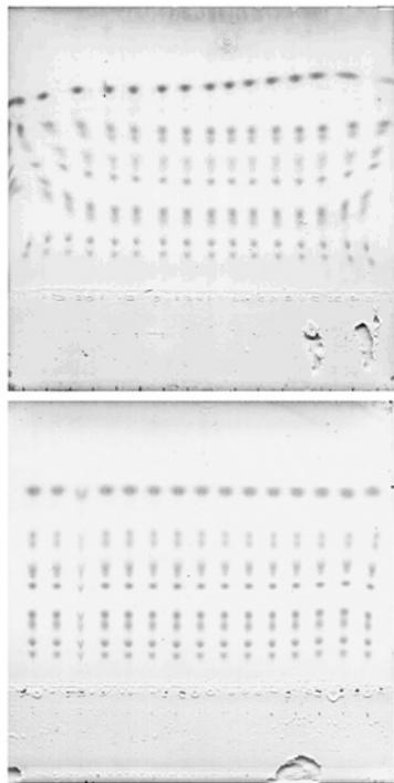
Abb. 6: Oben: Mit Standard-Lipidmix beladene DC-Platte in der Horizontalkammer entwickelt. Unten: identische DC-Platte in der Vertikalkammer entwickelt.
