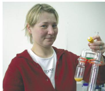
Abbildung 5: In dieser Schüttelapparatur wird aus dem Probenwasser das Sauerstoff-Isotopengemisch in übergeschichtetes \text{CO}_2 übertragen.
