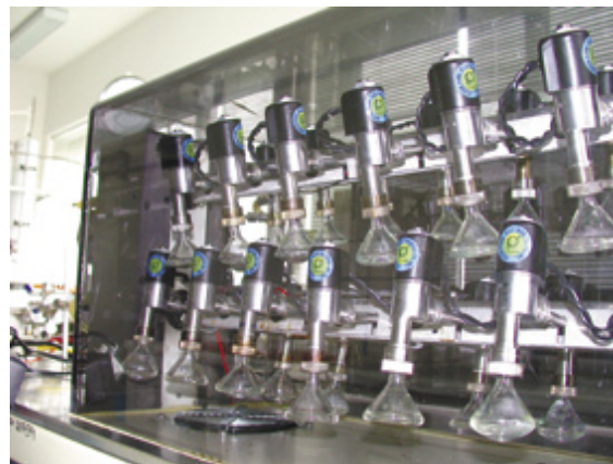
Abbildung 5: In dieser Schüttelapparatur wird aus dem Probenwasser das Sauerstoff-Isotopengemisch in übergeschichtetes \text{CO}_2 übertragen.
