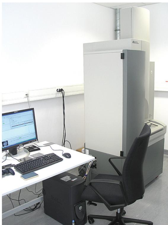
Der axial in dem Partikelfeld laufende Laserstrahl ist mit verantwortlich für die erheblich gesteigerte Empfindlichkeit des neuen Gerätes.
