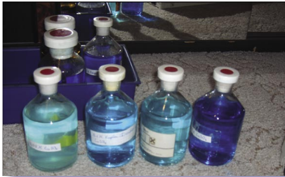
Abbildung 2: Durch die Farbintensität verschiedener Chemikalien (hier Kupfersulfat) und der daraus resultierenden Absorption in einem bestimmten Wellenlängenbereich kann man auf die Konzentration des Stoffes in der Lösung schließen.
