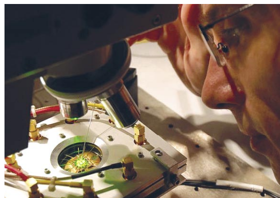
Programmierbares Submikroliter-Chiplabor (Foto: Thorsten Naeser, Universität Augsburg).
