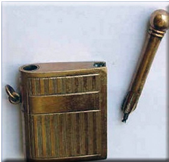
Abbildung 14: „Frack-Anzünder“ – Treibacher Feuerzeug: Ein mit Benzin getränkter Docht im Stahlröhrchen, das über den seitlich am Behälter angebrachten Auer-Zündstein gestrichen wurde, entzündete sich. (Bildquelle: XI).
