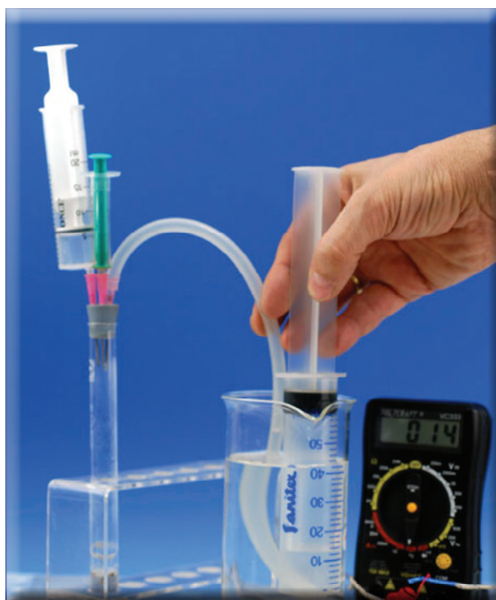
Abbildung 26: 38 mL Wasserstoff aus 1 Zündstein mit der Masse von 0,124 g.
