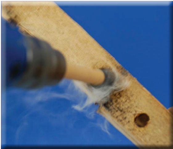
Abbildung 21: Feuerbohren mit Bohrmaschine, Hartholzdübel und Weichholzstück.
