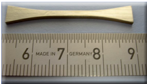
Metallisches Glas nach einem Zugversuch (Foto: IFW Dresden).
