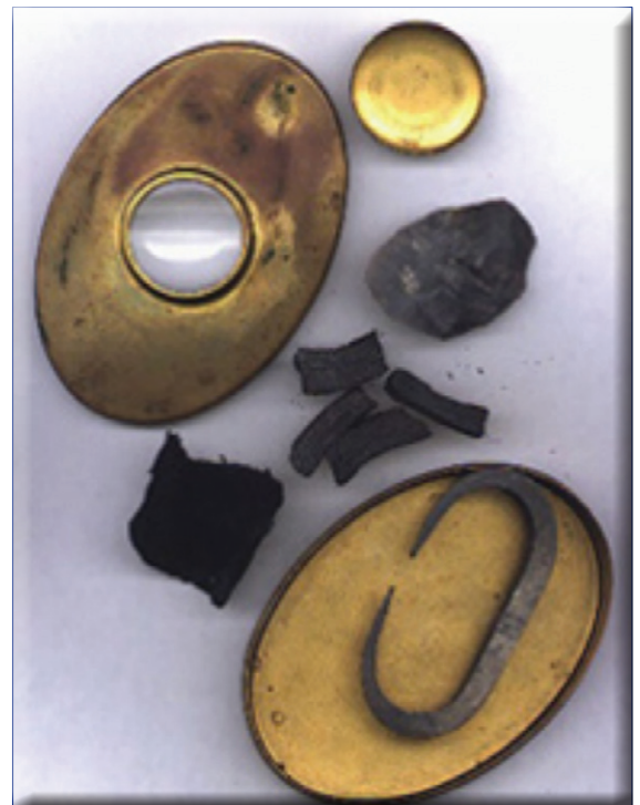
Abbildung 7: Alte Zunderbüchse aus Messing mit integrierter Brennlinse, Feuerstahl, Flint und Zunder, d. h. angekohlte Faserstoffe, bzw. Holzkohle (Bildquelle: VI).
