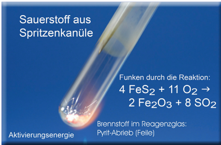
Abbildung 18: Funkensprühende Oxidation von erhitztem Pyrit-Abrieb in reinem Sauerstoff.
