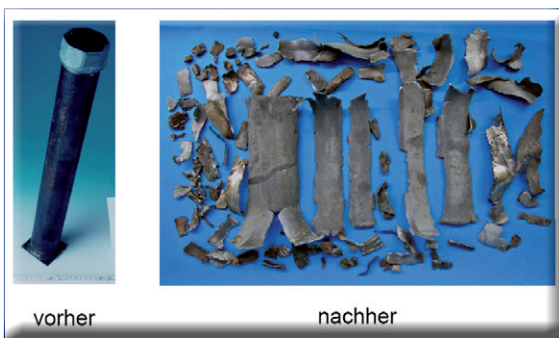
Abbildung 20: Test für explosive Stoffe und Gemische mit einer wesentlich größeren Stahlhülse als vorher (neue Stahlhülse vor und nach dem Test).
