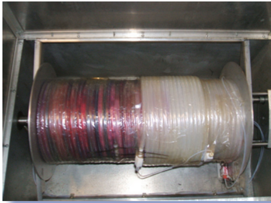
Abbildung 3: Trennung des XAD-7 Extrakts des schwarzen Karottenkonzentrats mittels LSRCCC.
