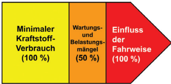
Abbildung 13: Mehr als die Hälfte des Kraftstoff-Verbrauchs unterliegen Wartung, Zusatzbelastungen und unökonomischer Fahrweise.
