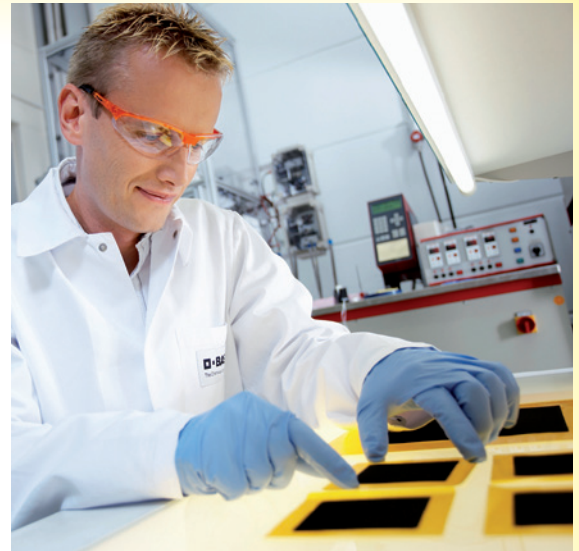
Bei der BASF Fuel Cell in Frankfurt wird das Herzstück der innovativen Brennstoffzelle hergestellt: die Membran-Elektroden-Einheit.
