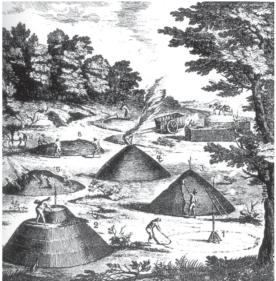
Abbildung 4: Historische Köhlerei zur Erzeugung von Holzkohle für die Eisengewinnung und zur Gewinnung von Kohlepulver zwecks Herstellung von Schwarzpulver (Zeichnung aus dem Jahr 1762).
