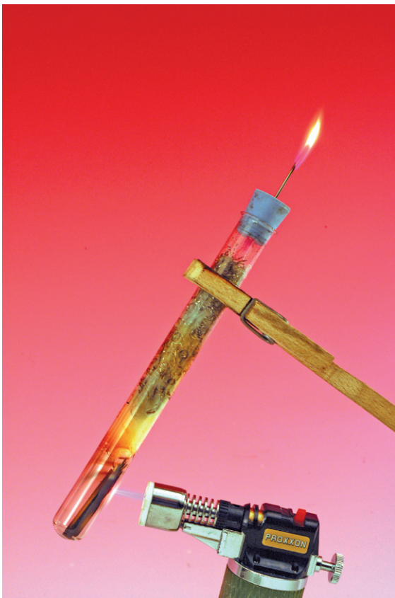
Abbildung 11: Low-Cost-Pyrolyse: Das Holzgas brennt an der Kanülenspitze.
