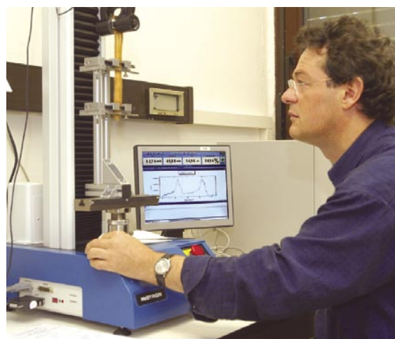
Abbildung 1: Zur Kämmkraftprüfung wird eine umgebaute Zugfestigkeitsprüfmaschine verwendet; unten: Dr. Claudius Schwarzwälder (alle Abbildungen: Wacker-Chemie GmbH, München).
