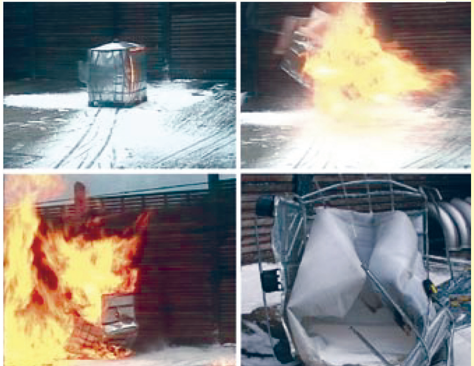
Der Feuerball einer inneren Explosion eines blechummantelten IBC, gefüllt mit fünf Litern Heptan: C_7H_{16} ist in Wasser unlöslich. Der Flammpunkt liegt bei minus vier, der Siedepunkt bei etwa 98 und die Zündtemperatur bei 285 Grad Celsius. Das Lösungsmittel ist also leichtentzündlich und gehört in die Gefahrklasse A I (Fotos: BG Chemie).
