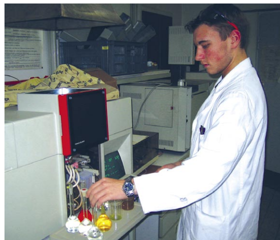
Bestimmung des Goldgehaltes mit Atomabsorptionsspektrometrie. Darunter: Zink in der Abfalllösung fein verteilt.
