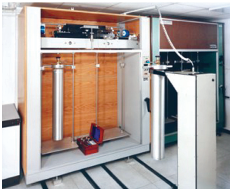
Abbildung 9: Mit der mechanischen Balkenwaage lässt sich eine Masse bis zu 20 kg mit einer Unsicherheit von \pm 6 mg bestimmen. Sie wird benutzt, um gasförmige Primärnormale gravimetrisch (durch sukzessives Einfüllen der Komponenten des Gemisches und ihrer anschließenden Wägung) mit der erforderlichen hohen Genauigkeit herzustellen.
