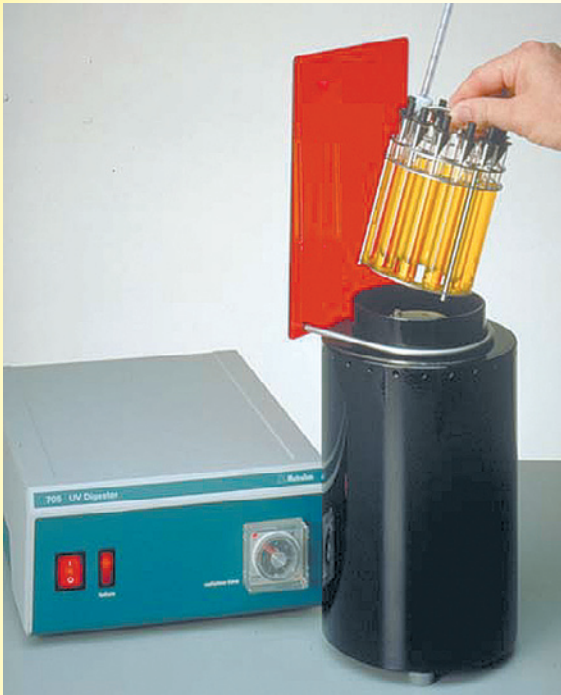
Beispiel einer UV-Auflösungs-Apparatur: Die zum Aussenden der UV-Strahlung verwendete 500 Watt Quecksilber-Hochdrucklampe erzeugt auch viel Wärme. Eine intensive Wasserkühlung führt sie ab (Foto: Metrohm).
