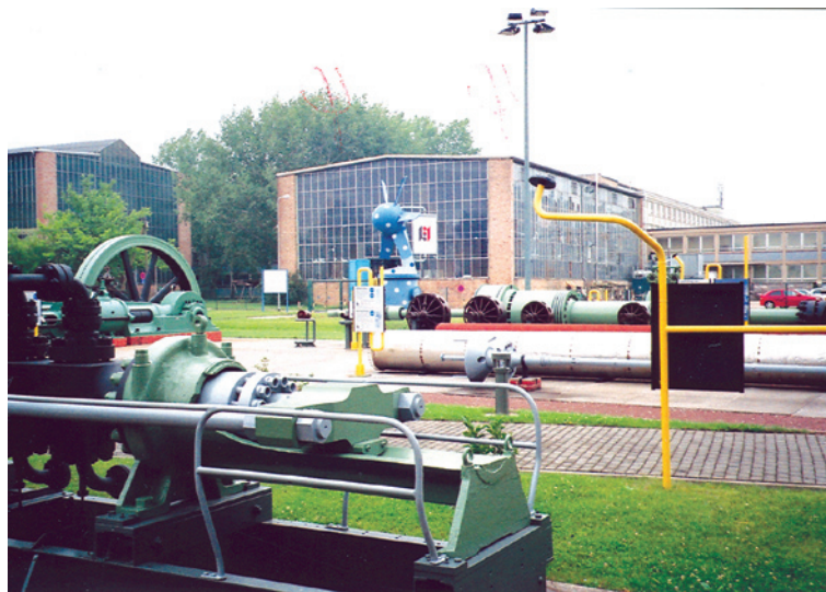
Abbildung 5: Blick über den Bereich der Kompressoren- und Pumpenstraße (links: Kupferlaugepresse mit Dampfmaschinenantrieb) auf ein Gebäude der FH Merseburg.
