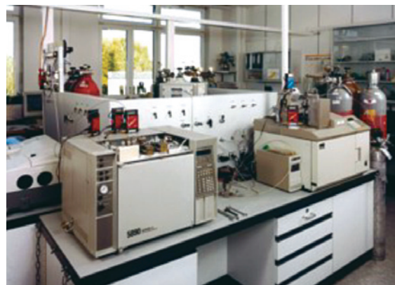
Abbildung 10: Zwei bis drei solcher Primärnormale vom gleichen Typ, jedoch mit unterschiedlichen Konzentrationen ihrer Gemischkomponenten, werden zur Kalibrierung des Gaschromatographen eingesetzt, mit dem die Zertifizierungsanalyse an einem Sekundärnormalkandidaten durchgeführt wird.
